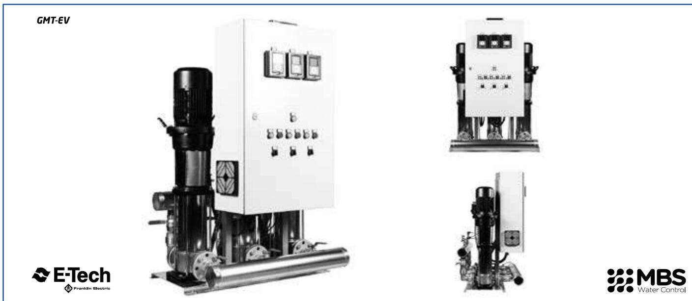
• Grupos de presión trifásicos de velocidad variable equipados con electrobombas EV y con un variador por bomba VACON® 100 FLOW, sistema Multimaster con rotación de la bomba principal.
