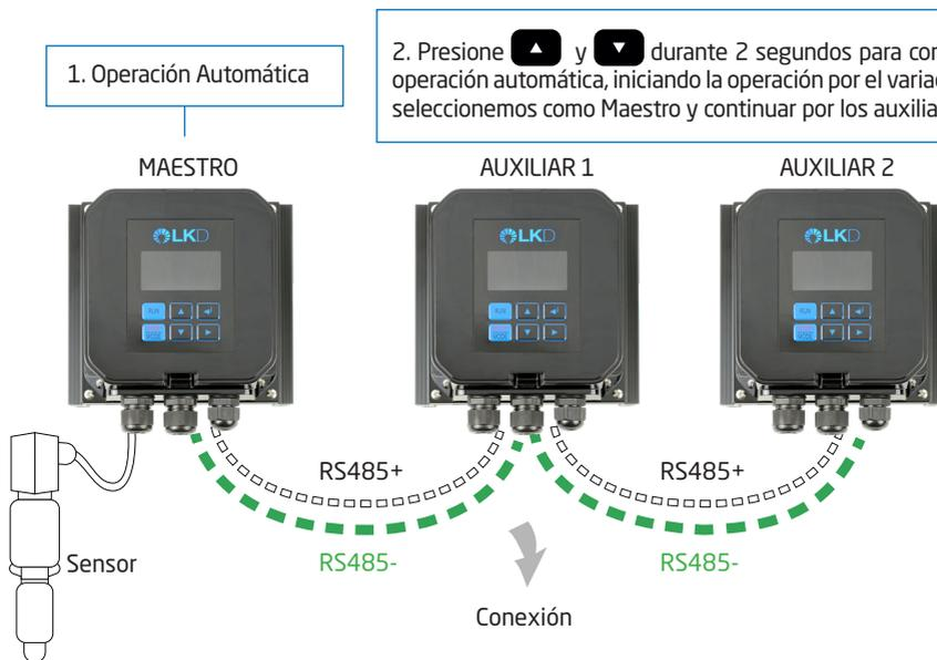
3. Tras activar la operación automática en los variadores, se mostrará en pantalla el número "1" en el equipo configurado como maestro, el número "2" en el auxiliar 1 y el número "3" en el auxiliar 2.
