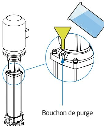
Pendant le processus de purge, les vannes et les bouchons de purge doivent être ouverts lentement, en faisant particulièrement attention à ne pas diriger le liquide vers des personnes ou des équipements électriques.
