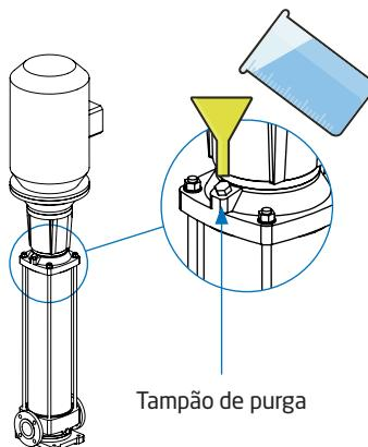
Durante o processo de purga do ar devem abrir-se as válvulas e os bujões de purga lentamente, prestando especial atenção em não dirigir o líquido para pessoas ou aparelhos elétricos.
