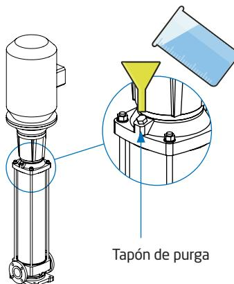
Durante el proceso de purgado de aire se debe abrir las válvulas y tapones de purga lentamente, prestando especial atención en no dirigir el líquido a personas ni aparatos eléctricos.
