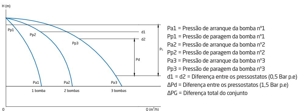
Para comprar o correto funcionamento do equipamento, coloque um de cada vez os seletores das bombas na posição "automático" (AUT). Abra ligeiramente a válvula da rede de distribuição e poderá comprovar as pressões de arranque e paragem automática de cada bomba. Uma vez terminado este exam, feche a válvula e coloque todos os seletores das bombas na posição "0".
