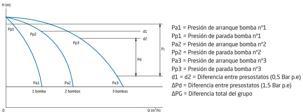
Para comprobar el correcto funcionamiento del equipo, coloque uno a uno los selectores de las bombas en posición "automático" (AUT). Abra ligeramente la válvula de la red de distribución y podrá comprobar las presiones de arranque y parada automática de cada bomba. Una vez terminada esta prueba, cierre la válvula y coloque todos los selectores de las bombas en posición "0".
