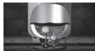
En la secuencia de fotos se puede apreciar como la membrana desplaza el agua del depósito por la presión de aire acumulada en la parte superior del mismo, y como los bordes bajan más rápido que el centro el cual se queda rezagado permitiendo el movimiento controlado de la membrana durante el ciclo de trabajo. En el proceso de expansión ocurre exactamente lo mismo.
